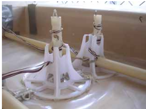
Figur 3b. Ställning med termoelement.
